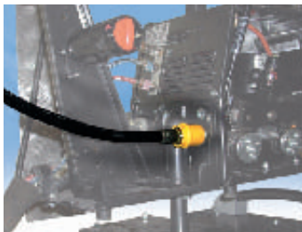
La instalación es simple y rápida como se muestra para el Marathon Pac™ Mini. El conducto de hilo se conecta mediante conectores rápidos al soporte guía (araña) bajo la tapa (mostrado como una cruz arriba) y al alimentador de hilo.
